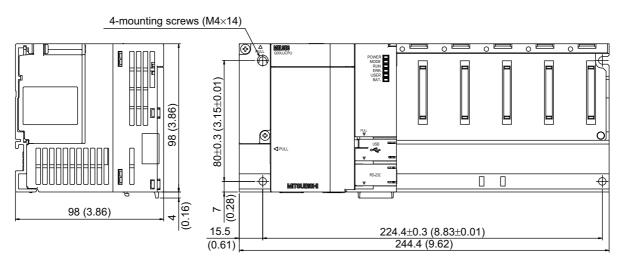
(3) Q00CPU, Q01CPU, Q00UCPU, Q01UCPU, Q02UCPU, Q03UDCPU, Q04UDHCPU, Q06UDHCPU, Q10UDHCPU, Q13UDHCPU, Q20UDHCPU, Q26UDHCPU
